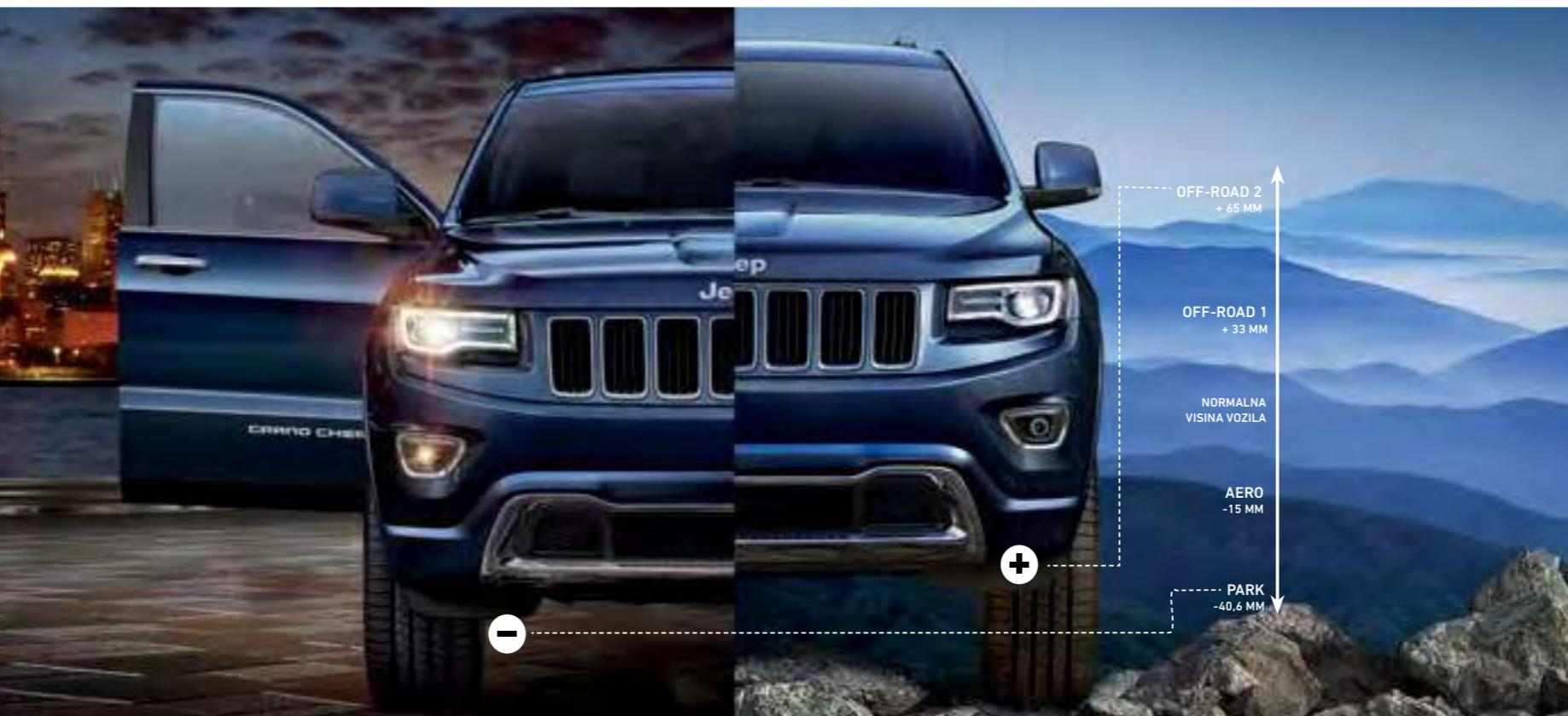
Ovaj sustav vozaču omogućuje da podigne novi Jeep® Grand Cherokee na impresivnu udaljenost od 287 mm od stijena i snijega ili ga za lakši ulazak, izlazak i utovar spusti na 40,6 mm od tla. Udaljenost od tla može se namještati u pet razina: normalna visina vožnje (NRH), Off Road 1, Off Road 2, Park način rada i Aero način rada.
