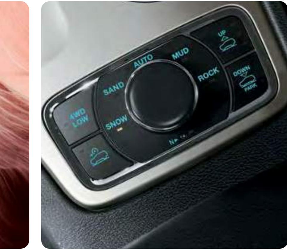
mjenjača i prijenosnog sklopa, kontrolu proklizavanja i elektronsku kontrolu stabilnosti vozila. Sustav omogućuje optimalne performanse: odaberite Sand, Mud, Auto, Snow i Rock načine rada. U Auto načinu rada, Selec-Terrain® održaje sav posao automatskim namještanjem dinamike vozila kako bi najbolje odgovarala svim vrstama terena.
