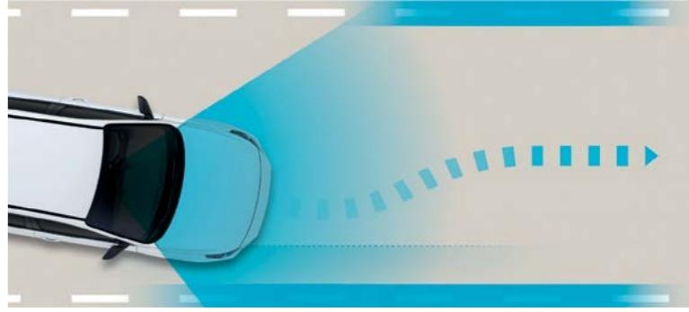
**Zadržavanje vozila unutar vozne trake (LKA).** Pri brzinama iznad 60 km/h sustav upozorava vozača na odstupanja unutar vozne trake. U slučaju neželjenog neželjenog odstupanja unutar vozne trake upozorava se vozača te se može primijeniti zakretanje upravljača kako bi se vozilo vratilo natrag u siguran položaj.
