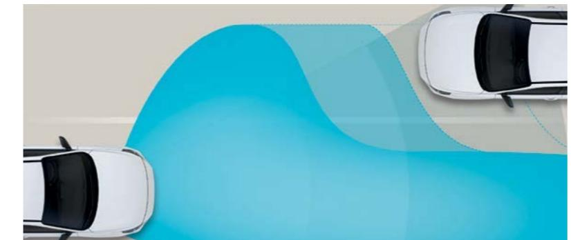
**Automatska duga svjetla (HBA).** High Beam Assist noću prepoznaće nadolazeća vozila iz suprotnog smjera kao i vozila u istoj voznoj traci ispred te prema potrebi automatski mijenja duga u kratka svjetla.
